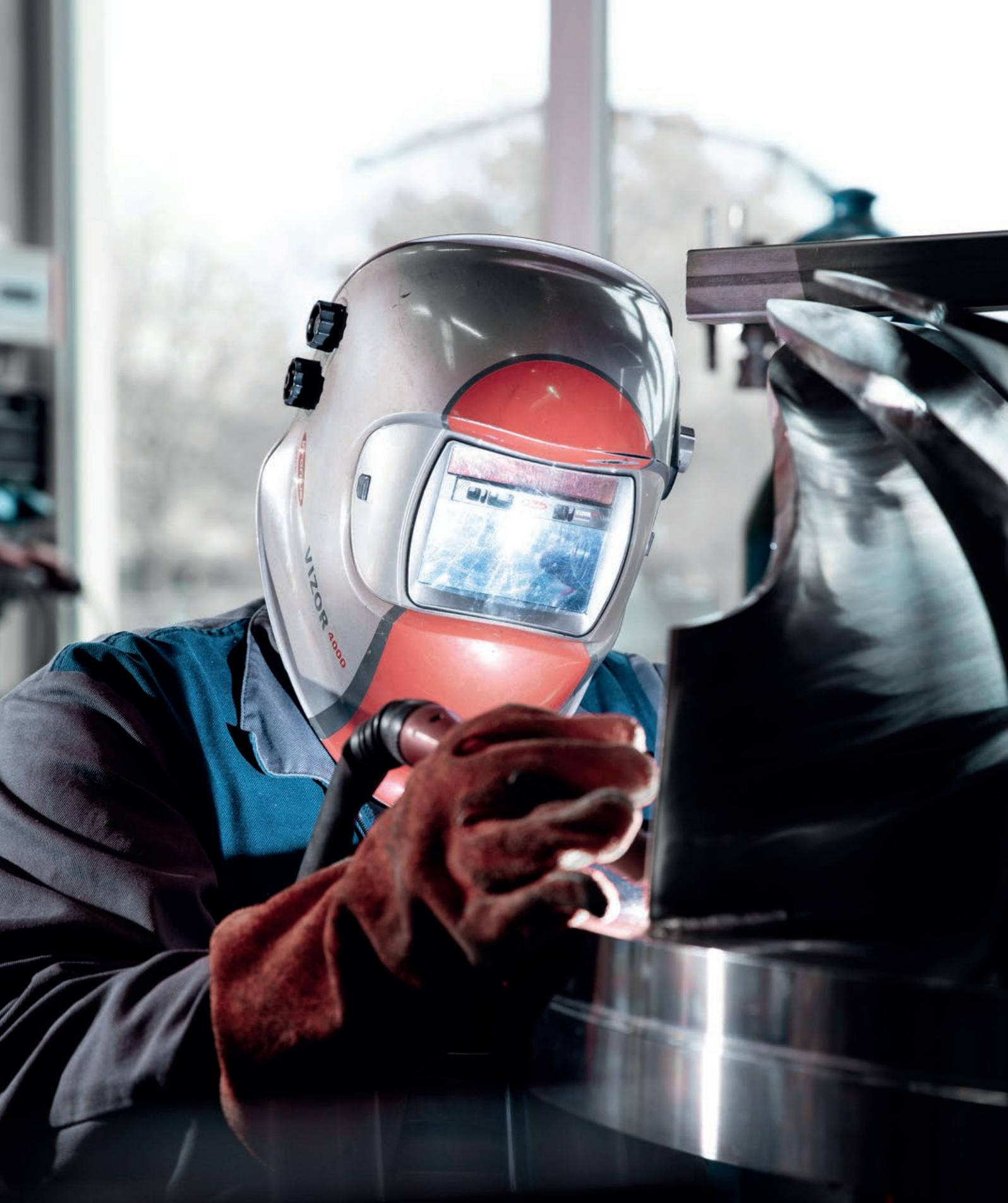
Im Fertigungsprozess von zwei- oder drei-teiligen Francis-Laufrädern werden mehrere Komponenten von Hand zusammengeschweißt. Um maximale Effizienz und Langlebigkeit zu gewährleisten, ist hier ein hohes Maß an handwerklichen Fähigkeiten und Präzision erforderlich.
