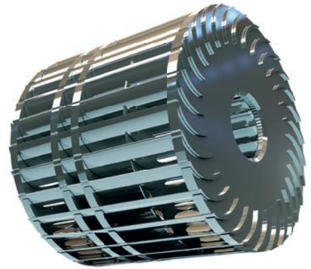
Die Durchström-Turbine ist aufgrund Ihrer relativ einfachen Bauweise sehr robust und langlebig. Speziell durch Ihren Einsatz bei Laufgewässern kann die Turbine bestmögliche Erträge erzielen. Im Vergleich zu anderen Turbinen, bringt der flache Wirkungsgradverlauf der Durchström-Turbine einen höheren Jahresertrag, da Laufgewässer oft über mehrere Monate eine schwache Wasserführung haben. Somit können die schwankenden Wassermengen bestmöglich genutzt werden.
