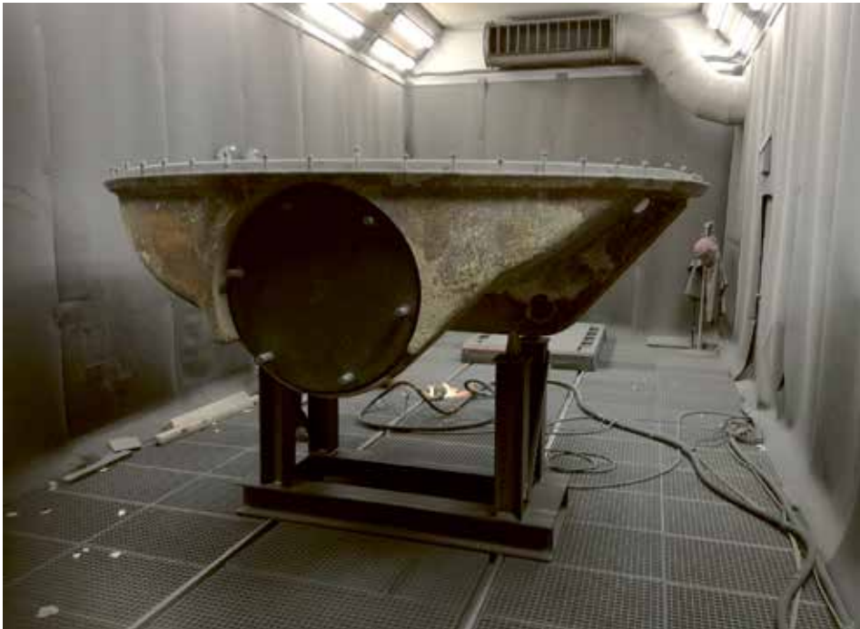
Abb. 6: Klappenteller auf einer Hilfskonstruktion während des Sandstrahlens
