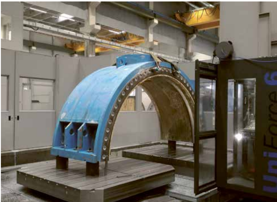
Abb. 7: Fräsbearbeitung bei einer Gehäusehälfte
